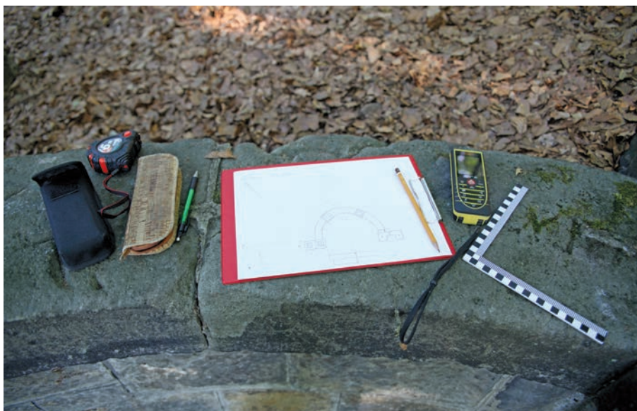
4.10 Pomůcky pro ruční stavební měření: svinovací metr, terénní zápisník, laserový metr s nivelací, pravouhlé fotografické měřítko. Dokumentaci usnadní využití laserového nivelačního kříže a fotoaparátu s digitálním horizontem, foto: David Skalický 2018.
