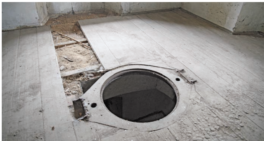
2.7 Relikty hydraulického žokovacího lisu, sušárna chmele v obci Postoloprty, p. č. 235-5, foto: Anna Lišková 2015.
