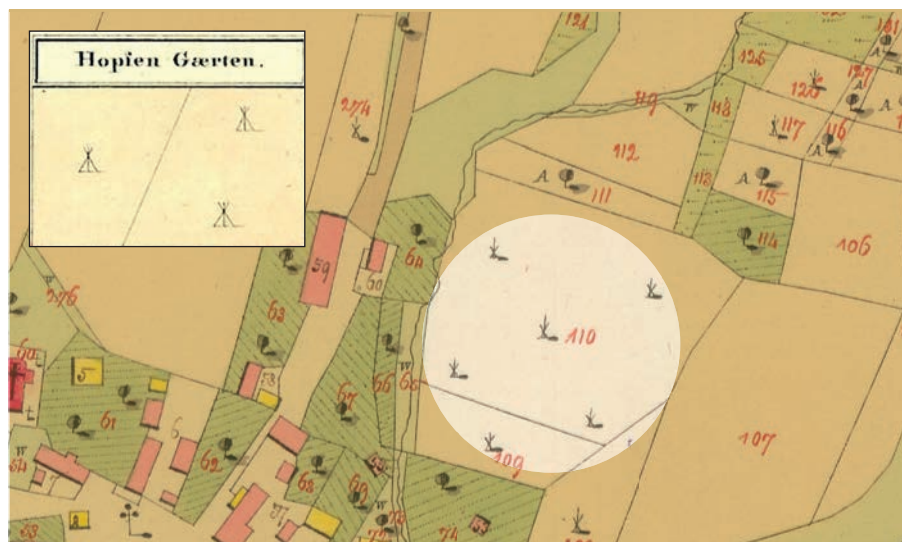
5.3. Výřez z císařského otisku indikační skici stabilního katastru s označením chmelnic topografickou značkou a legenda této topografické značky. Laboratoř geoinformatiky UJEP. [cit. 2019-09-11]. ( http://oldmaps.geolab.cz/stkatr/zoom/legenda.html ).
