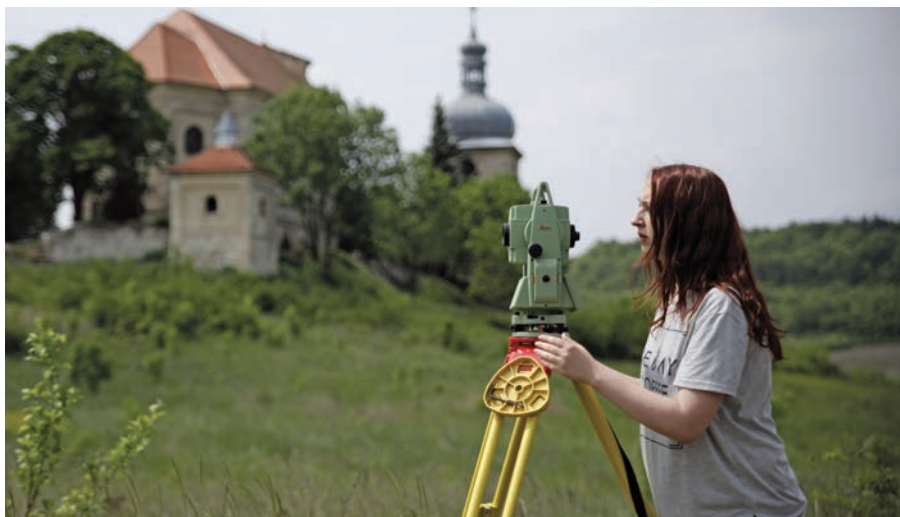
4.3 Vytyčování polygonového pořadu v terénu pomocí totální stanice, foto: Jan Horák 2016.
