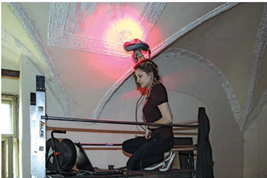
4.8 Skenování se s úspěchem využívá při dokumentaci detailů na sférických plochách, foto: David Skalický 2017.
