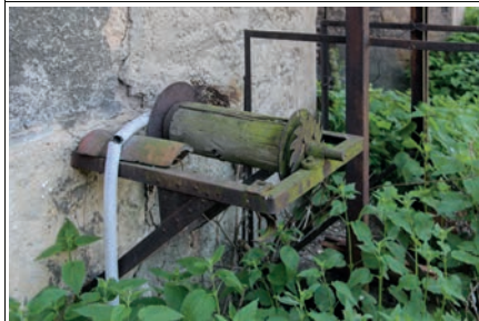
009 – Mechanismus ručního pohonu vrátku
