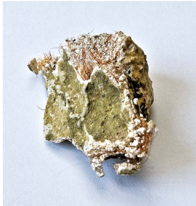
Obr. 13. Bukovec, kostel Nanebevzetí Panny Marie. Fragment vápenného tmelu z kružeb gotického okna na severovýchodní straně závěru presbyteria. Na vzorku jsou dobře patrné zbytky hovězích chlupů, které měly funkci armatury. (Foto L. Sommer, 2006)
