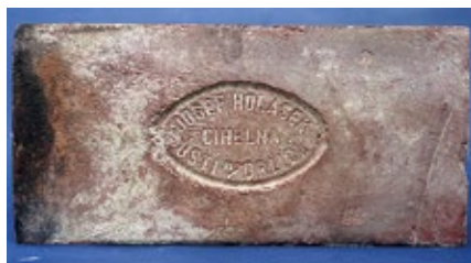
155/ A. Josef Holásek, Ústí nad Orlicí (UO), B. Dlouhá Třebová, zbořiště domku (UO), C. 1906 30. léta 20. století, D. JOSEF HOLASEK CIHELNA USTÍ N/ ORLICÍ, negativní písmo, negativní orámování oválu, lícovka E. VJ
