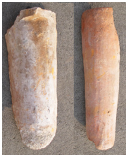
12 Javorník, kostel sv. Kříže, nález prejzové krytiny v krovu sakristie, kůrka, korýtko, 2012. Foto Eva Pulkrtová.
