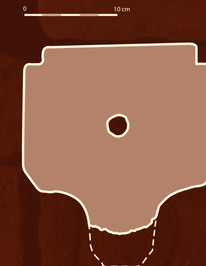
Detail přípoje na půdě severní boční lodi (vlevo); řez klenebním žebrem z 13. století (uprostřed) a středověká klenební tvarovka nalezená na půdě trojlodí (vpravo)
