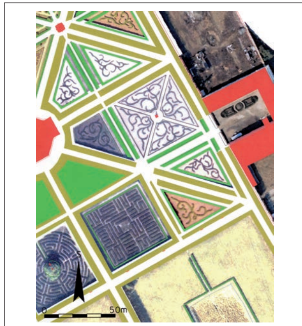
Obr. 57 Kroměříž – Květná zahrada. Detail fotogrammetrického plánu půdorysu vytvořeného doplněním vektorové kresby (zaměřené plošné a liniové prvky) o rastrové fotografické segmenty se složitými obrázky.
