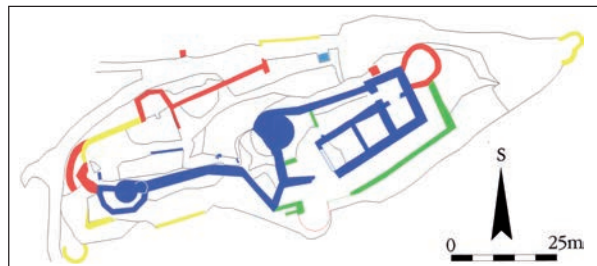
Obr. 49 Cimburk – hrad. Vektorový plán zaměřeného půdorysu hradu s rozlišením jednotlivých stavebních fází.
