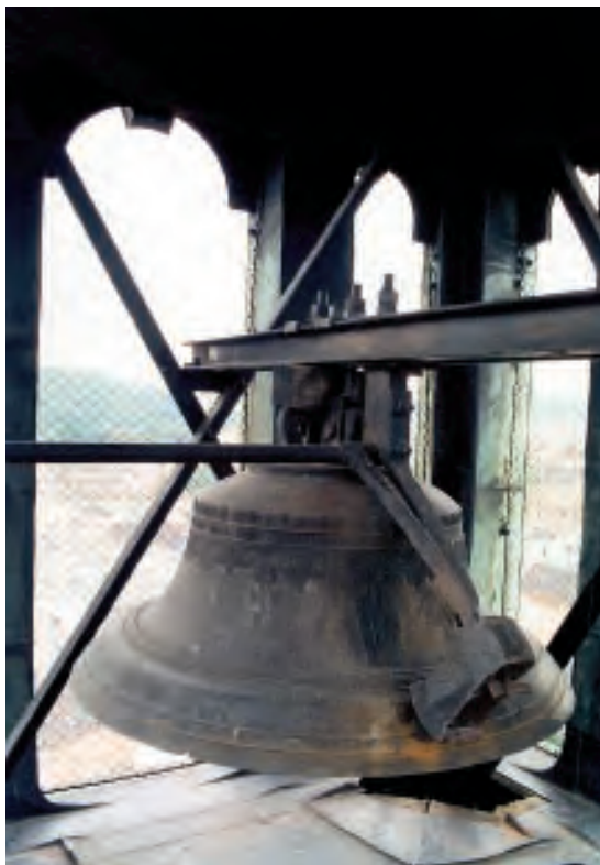
Kostel sv. Jakuba Většího, velká lucerna. Po impulsu bicího mechanismu věžního hodinového stroje udeří toto kladivo na plášť cimbálu z roku 1730 (malý cimbál – odbíjí čtvrtě). Nad ním zavěšený velký cimbál z roku 1593 odbíjí celé hodiny.
