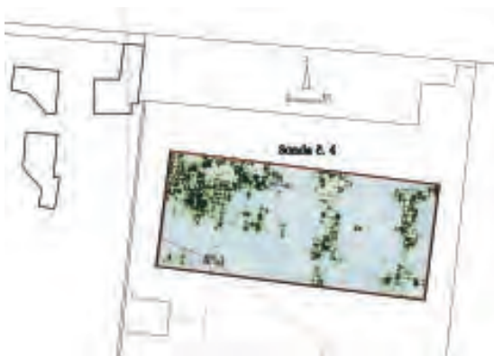
Sonda č. 4 – počítačové zobrazení anomálií na ploše měřené pulsním georadarem.
