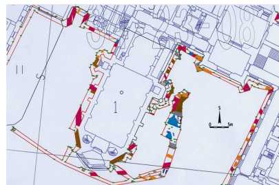
4) Detail plánu prozkoumaných ploch v prostoru mezi kaplí a JV křídlem zámku s vyznačením reliktů stok, podlah a zdí kamenných, kamenochelných a cihelných
