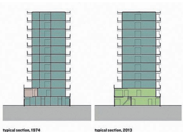
321. Řez budovou ukazuje změnu funkcí spodních podlaží ze skladovacích na coworkingové prostory. Nizozemí, Amsterdam-Zuidoost, sídliště Bijlmermeer. NL Architects a XVW architectuur, 2017. Přežato z: Wilkinson 2017.
