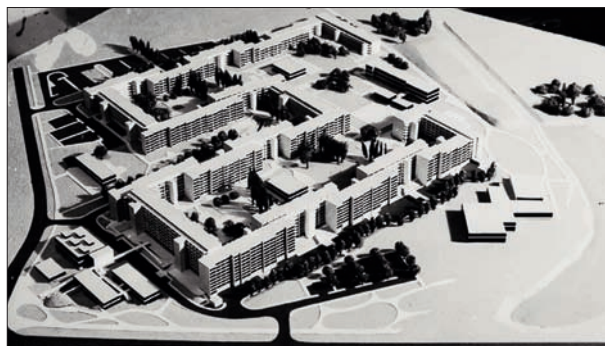
266. Jediná realizace pásového města ze sledovaných zemí, zde ovšem svinutá do půdorysu čtverce. Celým domem-souborem prochází pavlače-chodníky v oblacích. Byty jsou orientovány na jih a východ, pavlače na sever a západ. Polsko, Varšava, Przyczółek Grochowski. Oskar a Szofia Hansenovi, studie 50. léta 20. století, realizace 60. léta. Repró: Kedziorek/Stanek 2012.
