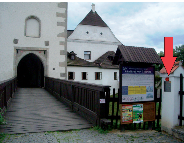
Obr. 3 Příklad aplikace klíčového trezoru požární ochrany (ve sloupku pod šipkou), který je umístěn na hradě Nové Hrady. (foto: Peichlová)
