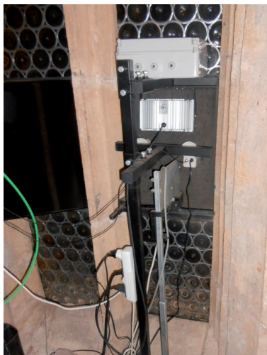
Obr. 7 Společný nosník, držící dvě kamery a IR reflektor.
