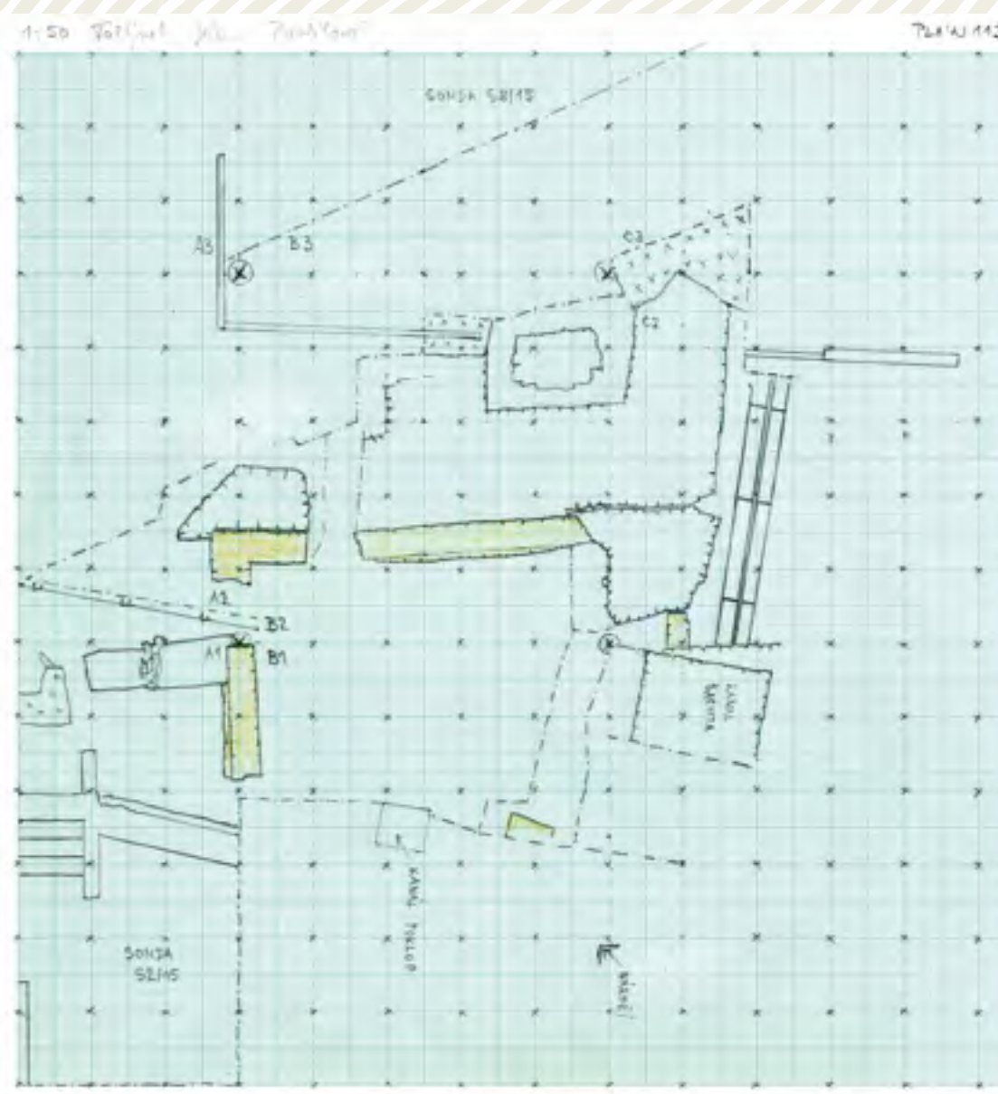
Obr. 8: Příklad terénní dokumentace zdiva kostela. Měřítko 1:50, archiv NPÚ, ÚOP v Olomouci
