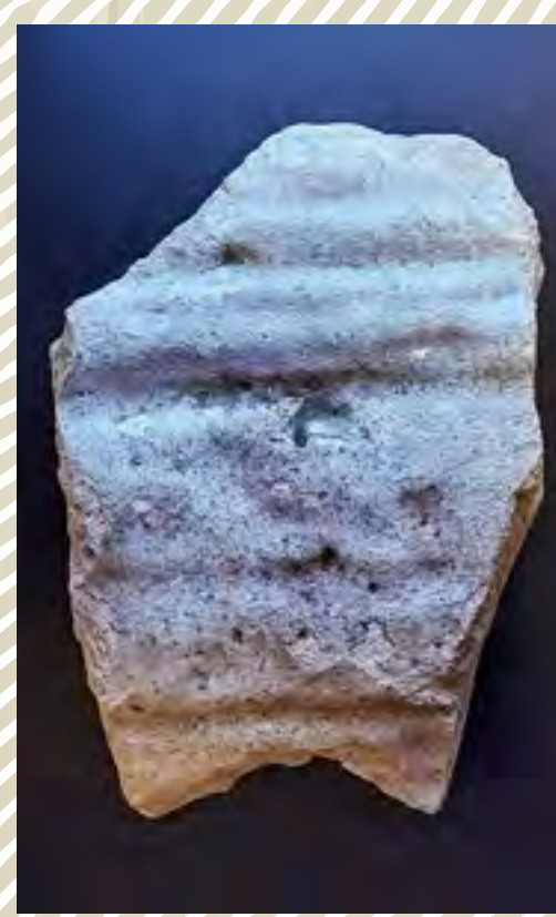
Zlomek okrajové části sklářské pánve s výraznými korozními rýhami, vzniklými působením tzv. hladinové koroze. Zaniklá sklárna Ostředek, pravděpodobně 1. období provozu v letech 1715–1719. Foto: J. Čáni, 2020
