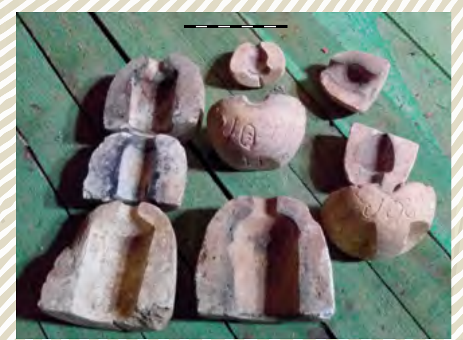
Keramické sklářské formy na láhve různé velikosti, nalezené v Chotěměřicích, k. ú. Zbraslavice, při stavebních úpravách pod podlahou domu č. p. 11, jenž se zřejmě nachází v místě zaniklé sklárny. Vzhledem k charakteru forem jde o 2. období provozu chotěměřické sklárny ve 30. až 60. letech 19. století. Foto: J. Čáni, 2019
