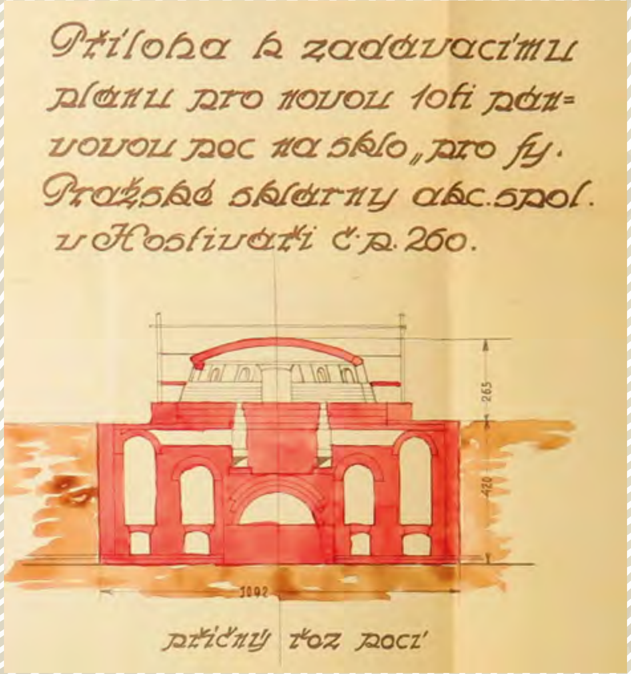
Pražské sklárny v Hostivaři, a.s. Plán pro stavbu nové pánvové pece, výřez. Autor plánu: Ing. František Stárek, 1925. Archiv hl. města Prahy, fond Magistrát hlavního města Prahy I. 1784-1949, Stavební úřad hlavního města Prahy 1883-1949
